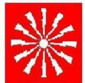
PULSANTE DI ALLARME ANTINCENDIO
